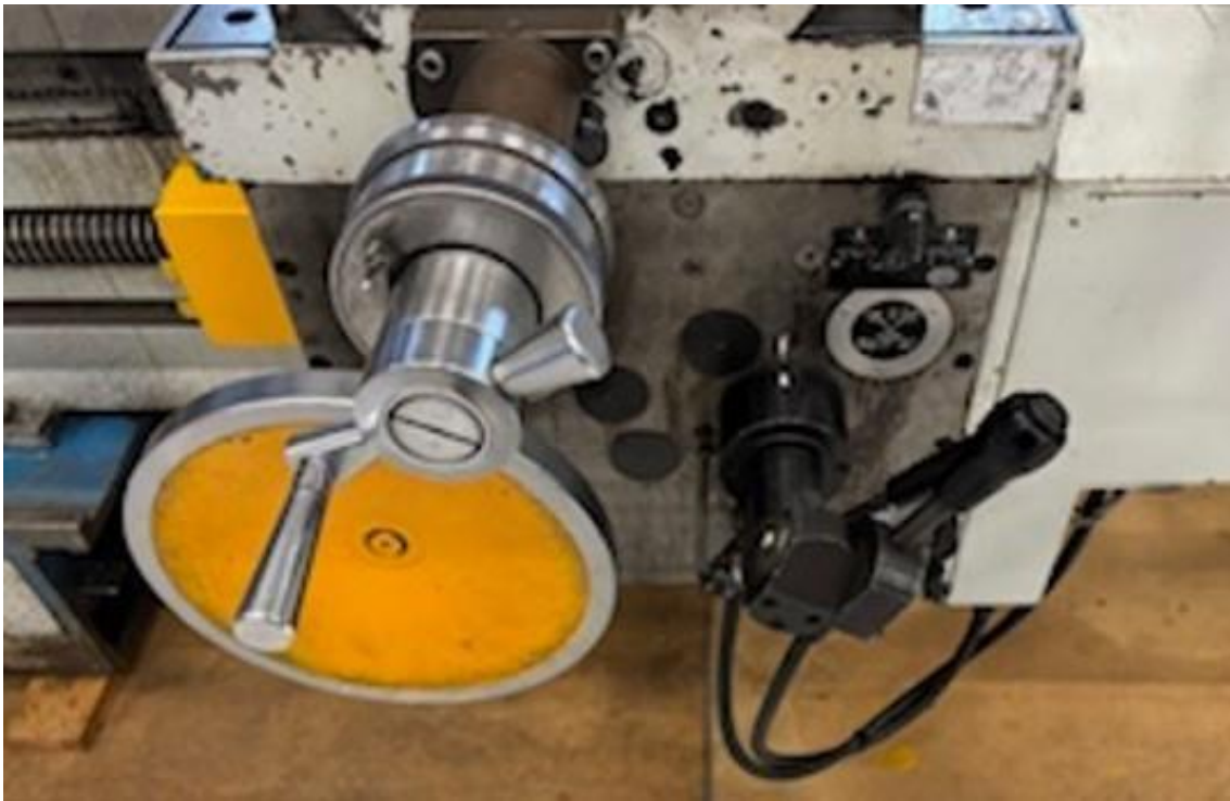
Foto N° 5: Avance automático y manual de los carros longitudinal y transversal.
