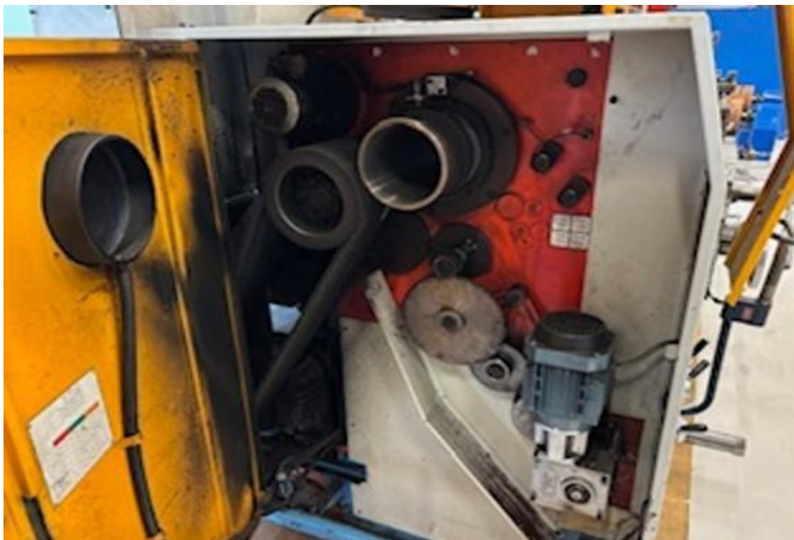
Foto N° 6: Mando motriz, tren de engranajes y entrada a la caja Norton.
