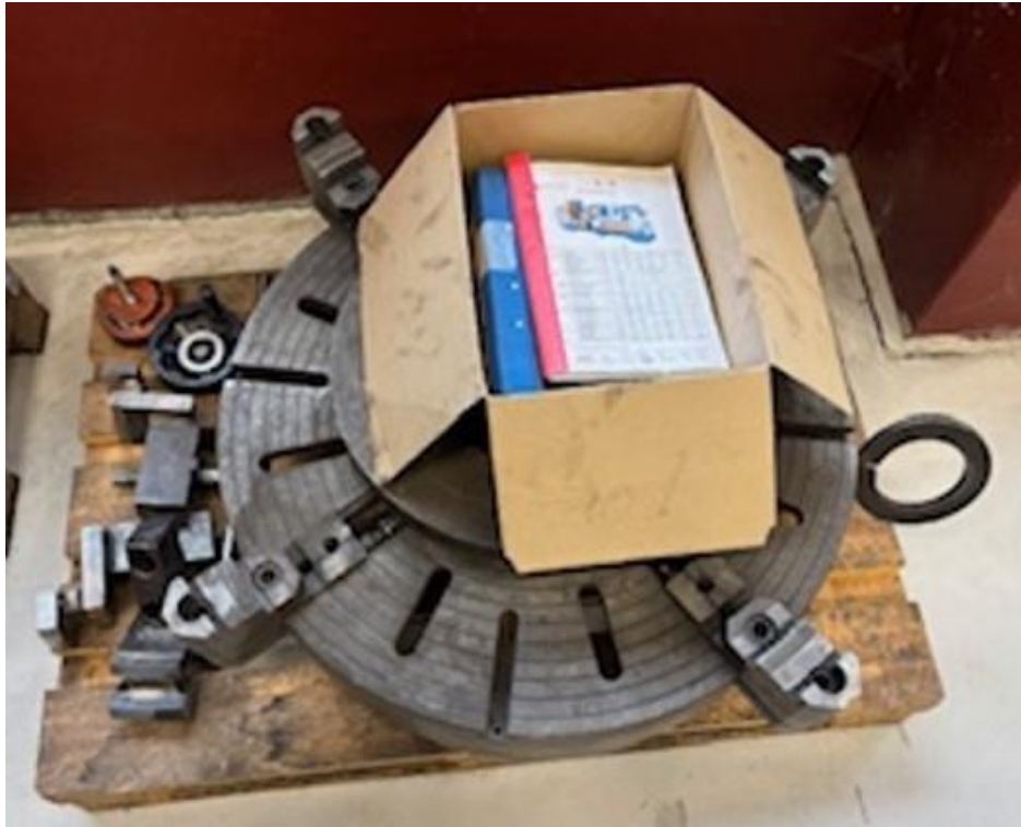
Foto N° 7: Mandril de 4 mordazas y accesorios de torneado.
