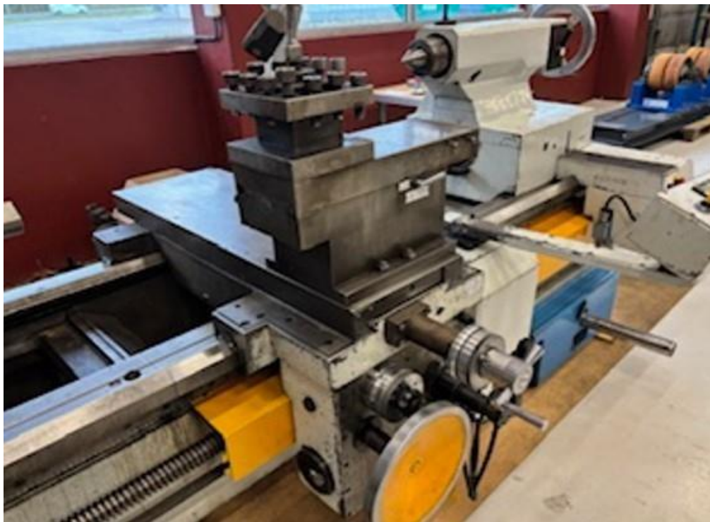
Foto N° 2: Carro longitudinal, transversal y torre portaherramientas.
