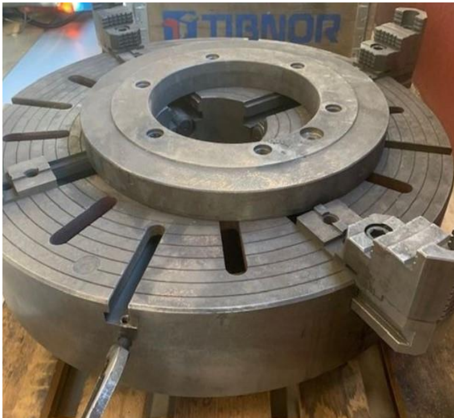
Foto N° 8: Mandril de 4 mordazas, diámetro de 800 mm.
