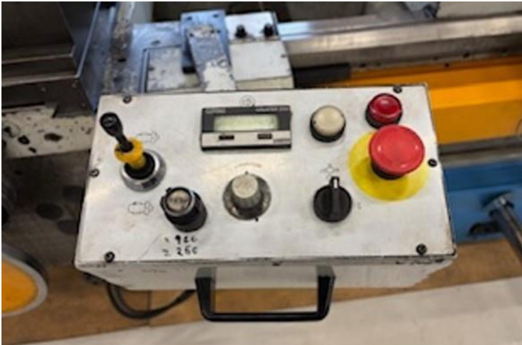
Foto N° 3: Control de velocidad variable del husillo.
