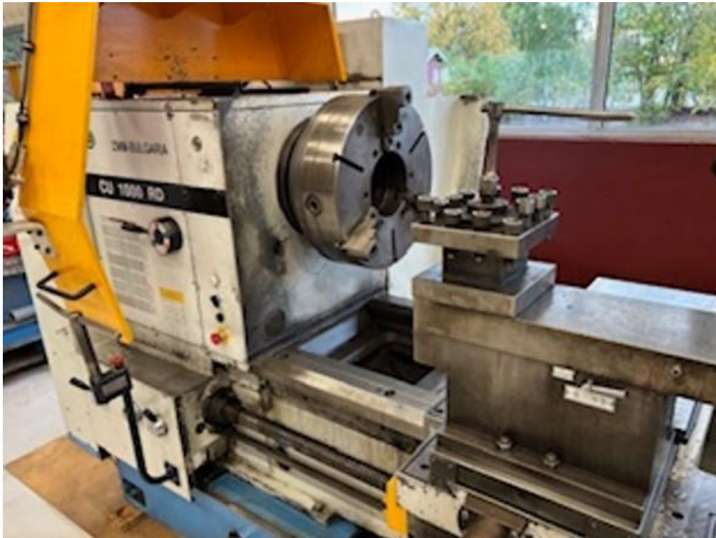
Foto N° 1: Mandril de 3 mordazas, diámetro de 500 mm.
