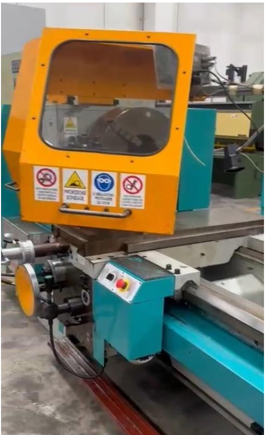
Foto N° 4: Protectores del torno contra virutas voladoras y refrigerante.
