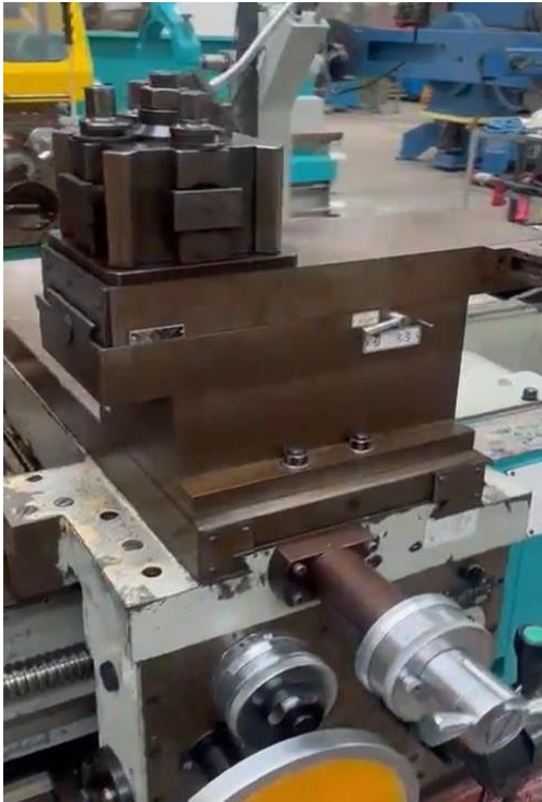
Foto N° 3: Carro transversal, torre portaherramienta y mandriles (400 y 800 mm)
