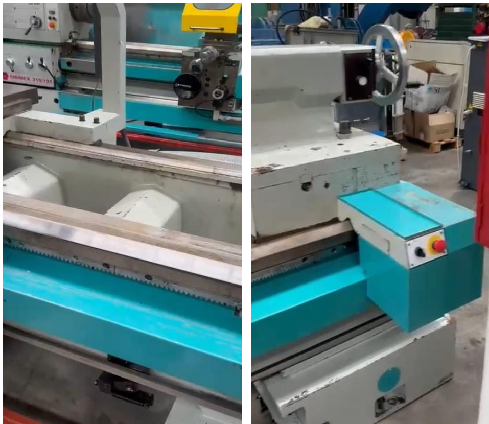
Foto N° 2: Bancada y contrapunto.
